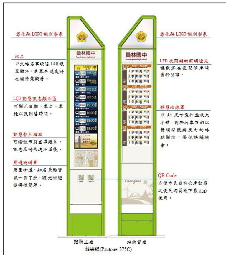
圖 7：獨立式 LCD 智慧型站牌示意圖
